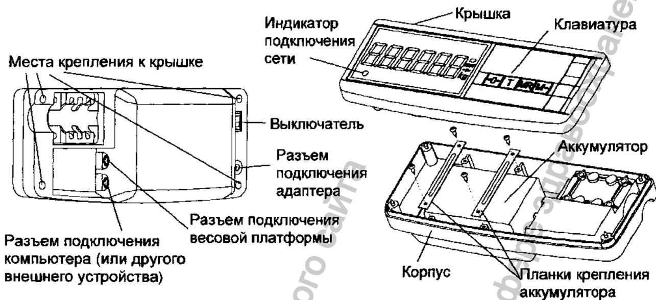
Рисунок 5.3 - Устройство индикации
