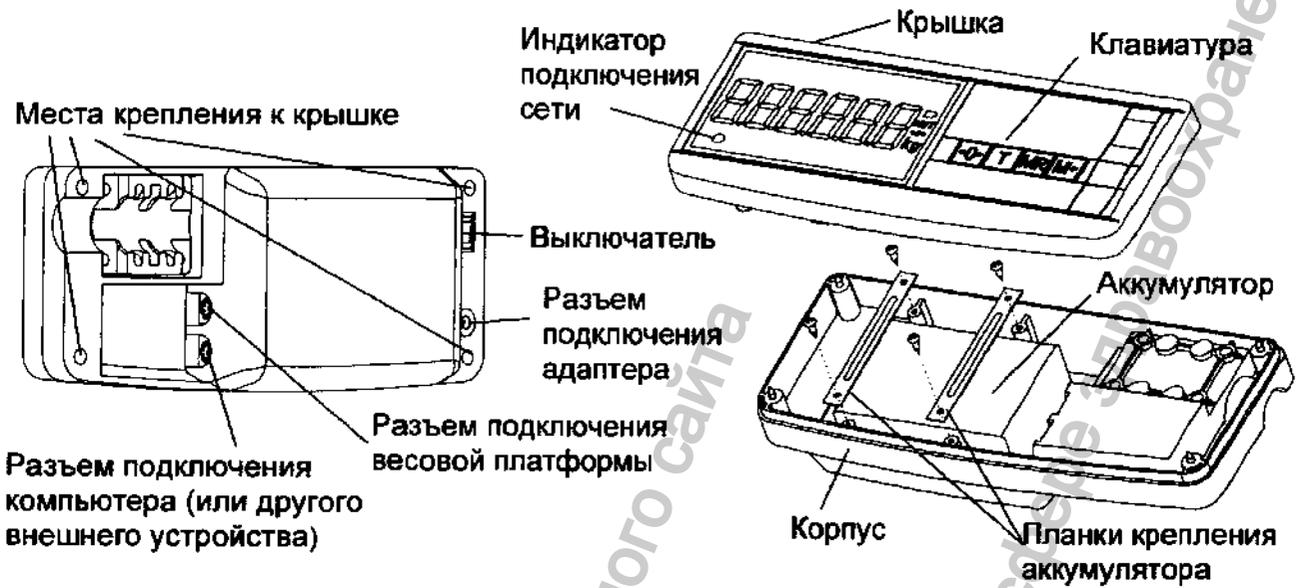
Рисунок 5.3 - Устройство индикации
